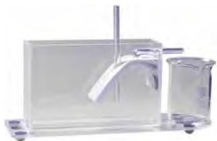
Maquette analogique pour l'étude du fonctionnement d'un piège pétrolier.
