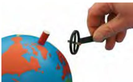
Maquette analogique permettant d'explorer et de comprendre la géométrie du champ magnétique terrestre.
